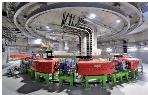
図2 大阪重粒子線センター内の加速器（直径17m）
