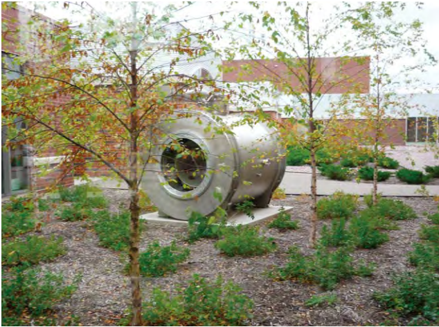
図1 ミネソタ大学医学部MR研究センター (CMRR) の中庭に記念モニュメントとして設置された第1号ヒト用4T MRIのマグネットコイル
